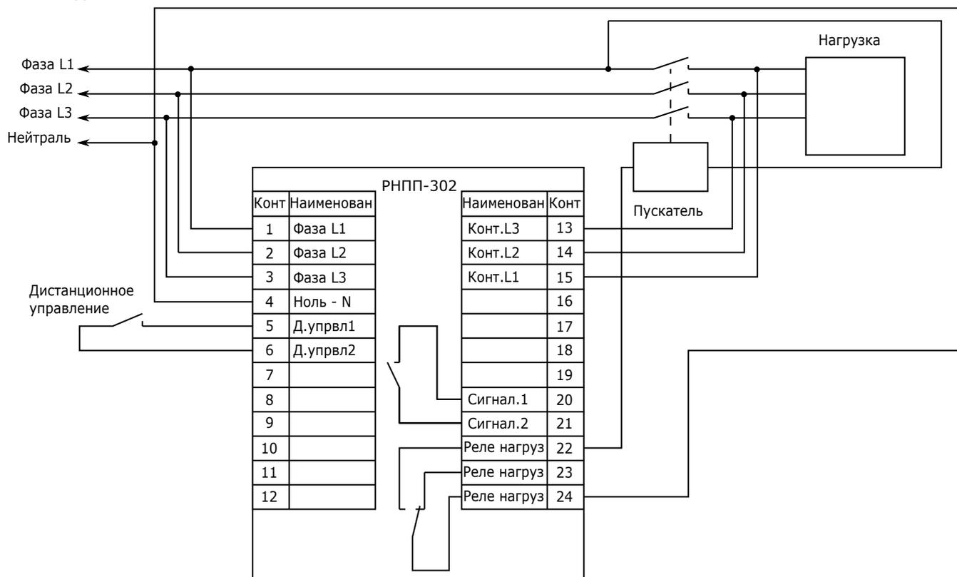
Схема подключения РНПП-302 к трехфазной сети с глухозаземленной нейтралью.
